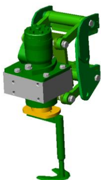
Фиг. 9. Култиватор с автоматично завъртащи се ножове
