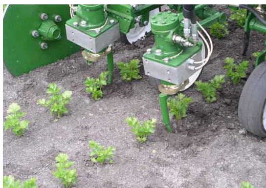
Фиг. 9. Култиватор с автоматично завъртащи се ножове
