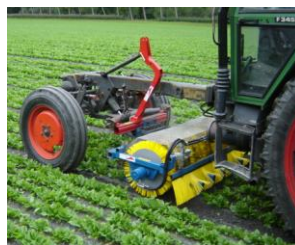
Фиг. 6. Четков култиватор (поглед отзад): 1 – основа на барабана; 2 – пластмасови влакна; 3 – предпазен тунел
