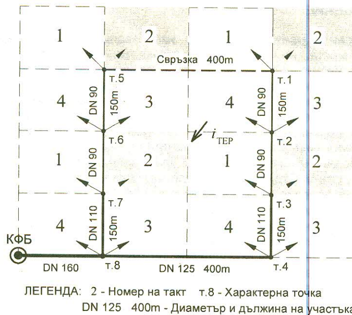
Фиг. 1. Технологична карта 1 и диаметри на тръбопроводите
